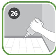
После удаления всех расширительных клиньев закрепите плинтуса поверх выступающего края пароизоляции (полиэтиленовой плёнки). Помните, что вам нужно дать полу возможность расширяться и сжиматься под плинтусом, поэтому никогда не крепите плинтуса непосредственно к полу, а крепите к стене.
