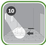
Начните установку досок в правом верхнем углу помещения. Первую доску следует укладывать гребнем к стене.
