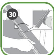
Обрежьте выступающую часть замковой системы (гребень) по всей длине доски. Нанесите на полученный после обрезки край доски столярный клей и, уложив доску, плотно прижмите к предыдущему ряду. Вставьте расширительные клинья.
