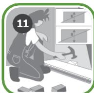
Между полом CORKART и стеной, а также всеми неподвижными элементами, такими как трубы отопления и дверные рамы, всегда требуется делать зазор толщиной не менее 10 мм. Чтобы обеспечить идеальный деформационный шов, необходимо отпиливать выступающие части замковой системы.
