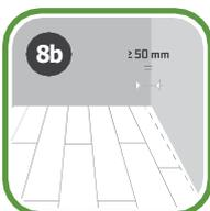
Измерьте ширину комнаты, а затем разделите ширину комнаты на ширину доски. Если последний ряд досок будет уже 50 мм, вам нужно будет обрезать первый ряд досок, чтобы сделать его более узким. Сделайте простой шаблон для отметок ширины (кусочек дерева или доски) и разметьте доску вдоль стены. Отрежьте доски вдоль, включая гребни замковой системы.
