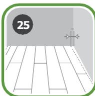
Ширина последнего ряда должна быть не менее 50мм. Перед измерением установите к стене клин. Сделайте простой инструмент для разметки (брусок дерева) и отметьте доску вдоль стены. Разрежьте доски вдоль, включая элементы замковой системы.
