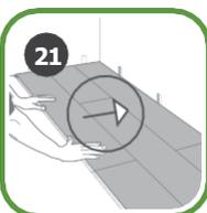
После 2-3 рядов. Отрегулируйте расстояние до передней стены, установив расширительные клинья. Удерживайте их на месте в течение всего времени установки и снимите после завершения установки.
