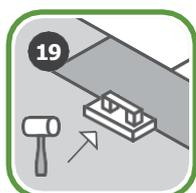
Начиная со второго ряда, мы рекомендуем использовать ПРАВИЛЬНЫЙ подбивной блок и резиновый молоток как по вертикали, так и по горизонтали, чтобы обеспечить плотное прилегание досок друг к другу
