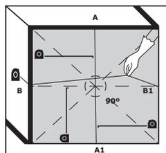
Найдите центр стены при помощи мелового шнура. Нарисуйте две линии от центра границы стены А до центра противоположной границы стены А1 и от центра границы стены В до центра противоположной границы стены В1. Проверьте, образует ли пересечение двух линий угол 90°.
