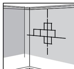
Убедитесь, что ширина плитки в углах больше 5 см. При необходимости повторите предыдущий шаг, начертив новые параллельные линии относительно первых. Отметьте положение первой плитки. Наилучшее расположение в точке пересечения линий.
